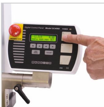
^ Die up/down/stop Knöpfe wurden für die Industrie in robustem Aluminium gefertigt. Die Knöpfe zum Nullen des Verfahrensweges und der FollowMe™ Funktion wurden als weiterer Komfort separat dem Panel hinzugefügt.
