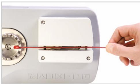
^ Das Prüfgerät startet automatisch sobald der Prüfling eingelegt ist. Nach der Prüfung, dem Bruch des Prüflings, fährt das WT3-201M zurück in die Ausgangsposition. Probegrößen bis AWG 3 (6.3 mm) können verarbeitet werden.
