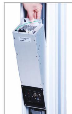
^ Die meiste Elektronik ist in einem integrierten Gehäuse untergebracht, wodurch der Zugang wie auch der Wechsel bei Updates oder Services vereinfacht ist.
