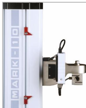
^ Obere und untere mechanische Endanschläge stoppen den Prüfstand mit einer Wiederholgenauigkeit von 0,025 mm.
