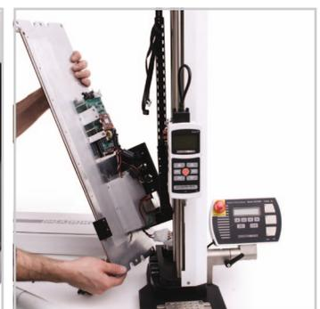
^ Die gesamte Elektronik ist auf einer einzigen Panele angebracht, wodurch der Zugang wie auch der Wechsel bei Updates oder Services vereinfacht ist.
