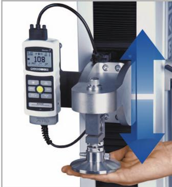
^ Das Querhaupt reagiert auf Bewegungen durch Drücken oder Ziehen an der Messzelle oder am Messgerät. Ideal für das Einrichten und schnelles Positionieren.
