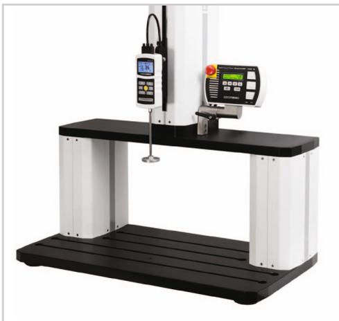
^ Doppelsäulenerweiterung für Prüflinge bis 508 mm Länge oder Ø 546 mm (in der Ausführung 150 mm). Verfügbare Höhen: 150, 300 und 600 mm. Die Grundplatte verfügt über T-Nuten für die Montage von Halterungen.
