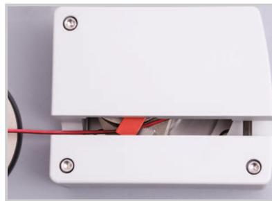
^ Sobald der Test beginnt, wird der Prüfling von Nocken eingerastet und gezogen. Um die Sicherheit zu erhöhen, fährt ein Klemmschutz (roter Griff im Bild) automatisch in Position.
