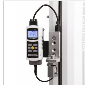
^ Anzeigegerät + Lastzellen-Adapter, passend für Kraftsensoren der Serie MR01 oder MR03. Inkl. Befestigungszubehör
