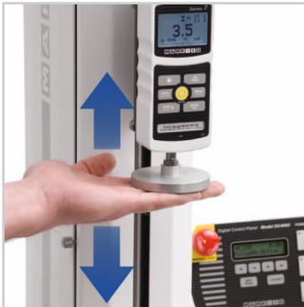
^ Das Querhaupt reagiert auf Bewegungen durch Drücken oder Ziehen an der Messzelle oder am Messgerät. Ideal für das Einrichten und schnelles Positionieren.
