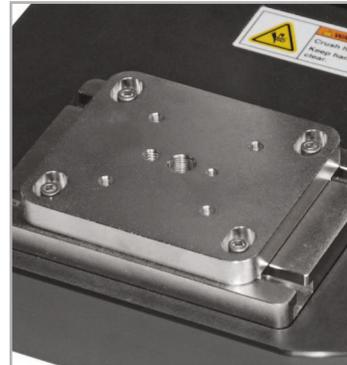
^ Optionale Befestigungsplatte mit #10-32, 5/16-18 und 1/2-20 Gewindebohrungen.
