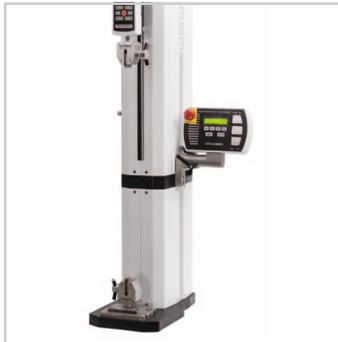
^ Erweitert den vertikalen Abstand für hohe oder lange Prüflinge mit einer Säulenerweiterung. Drei Erweiterungen sind möglich: 150, 300 und 600 mm
