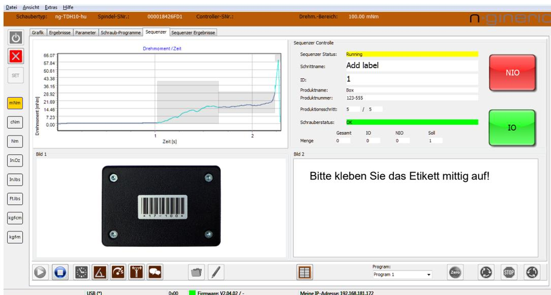
Beispielhafte Instruktionen an den Bediener bei frei definierbarem Montageschritt
