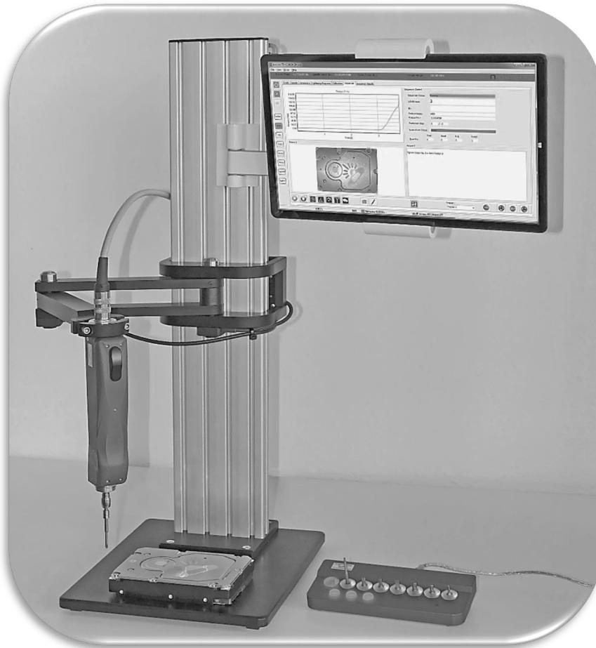
Gerätehalter mit vertikaler Linearführung und zwei Gelenkachsen
